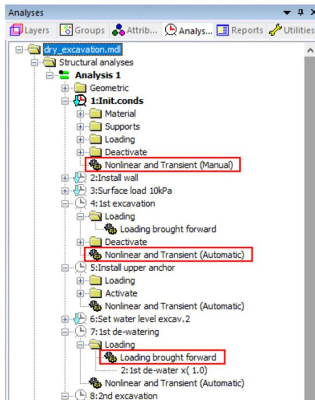
'Loading brought forward' 항목을 클릭하면, 해당 하중케이스 또는 하중단계(Stage)에 대해 이전 단계에서 어떤 하중이 이어지는지 여부를 보여주는 대화창이 열립니다. 여러 개의 탭으로 나누어 표시하며, 각 탭에는 LUSAS Solver가 이전 단계에서 계속 적용하는 하중들이 정리되어 있고, 하중이 계속 적용되는 경우와 적용되지 않는 경우 모두에 대해 그 이유가 함께 명시됩니다.
